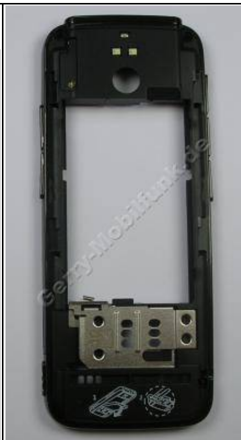
Unterschale, Gehäuseträger schwarz Nokia 5630 XpressMusic Gehäuseträger mit Simkartenhalter, Speicherkartenabdeckung, Seitentasten für Lautstärke, Musikplayer, Fototaste, Foto-LEDs (black) (269381)
