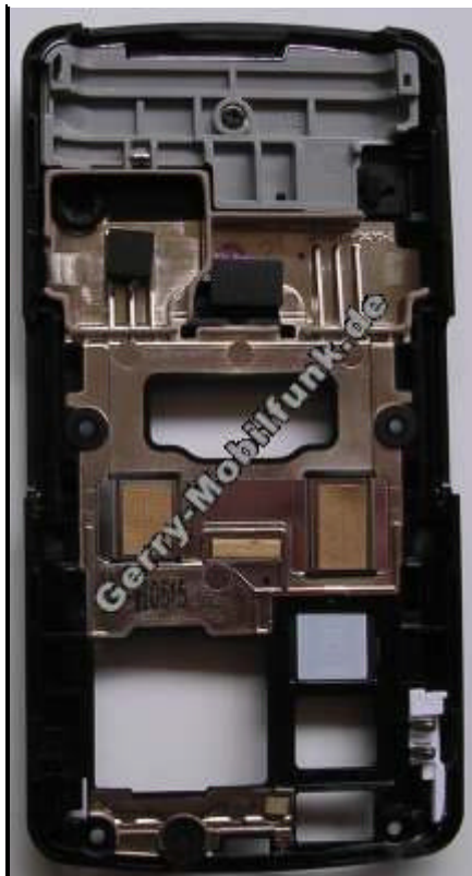
Unterschale Tastatur schwarz LG KG800 Chocolate, original Gehäuserahmen zur Aufnahme des Akku(9981021)
