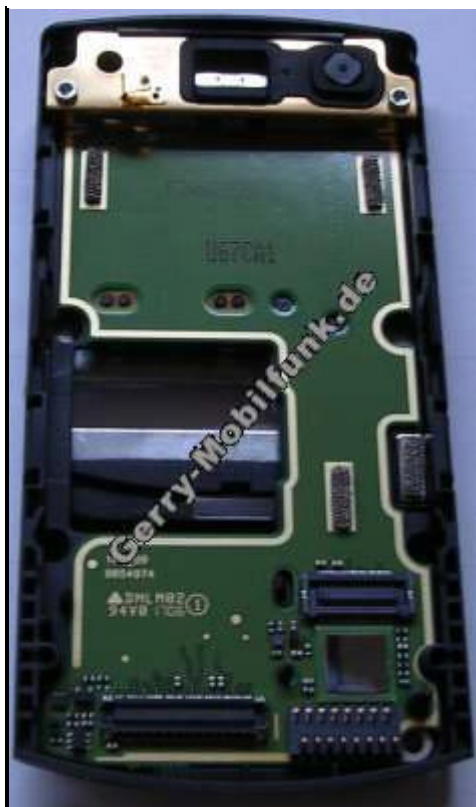
Kompletter Schieber Nokia N80 schwarz, Slider incl. Schiebemechanik, Kamera und Platine(17170)
